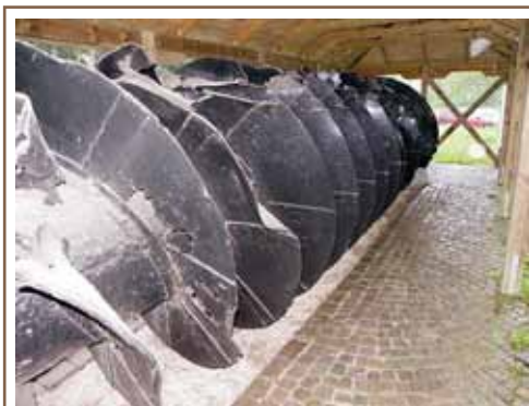
En arkimedesskruv som användes i slutet av 1800-talet för att torrlägga Nosabysjön, Kristianstad. Skruven drevs med en ångmaskin.
